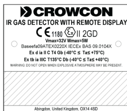
Etiqueta de certificação do IRmax com Barreira IS
