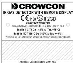
Etykieta certyfikatu iskrobezpieczeństwa urzędu IRmax
