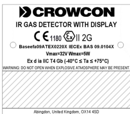
Certificatie-etiket voor IRmax met vast IR Display
